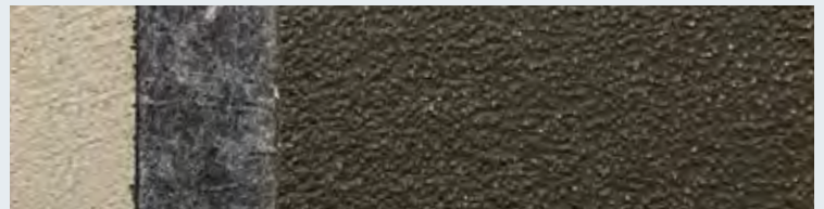
Primer Sheet Membrane MACoat Application
